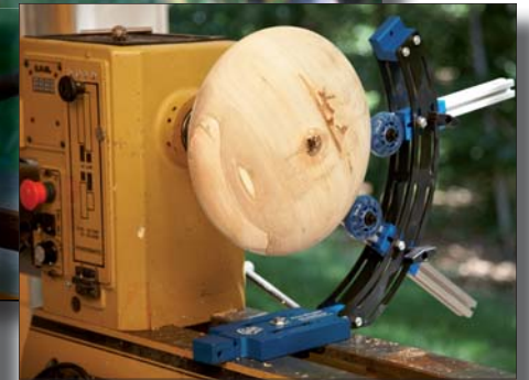
MultiRest в положении поддержки с одной стороны
