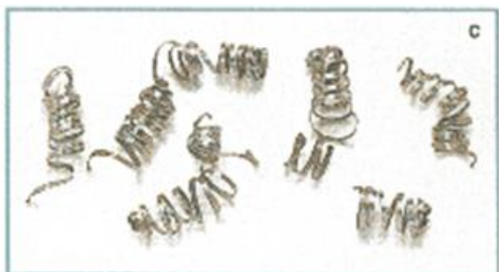
Свободно намотанная (витая) стружка - идеальные условия резания
