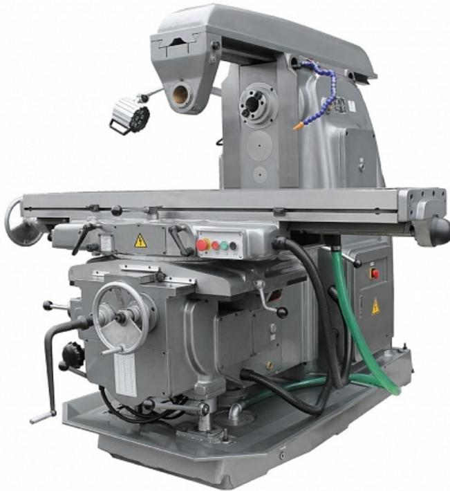
Модель JET JHM-1667 может использоваться как в единичном производстве в небольших мастерских, на ремонтно-механических и инструментальных участках, так и на крупных промышленных предприятиях в серийном производстве деталей с использованием функций автоматических и полуавтоматических циклов.
