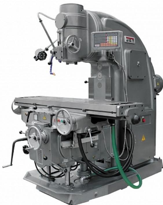
Для расширения функциональности станка, фрезерная головка имеет возможность наклона влево/право в диапазоне  $\pm 45^\circ$
