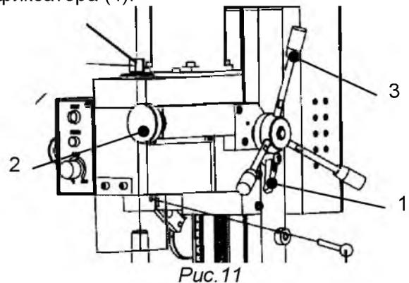
Быстрое перемещение (подъем и опускание) фрезерной головки производится поворотом рукояток вертикальной подачи. Величина перемещения контролируется по шкале на стойке или выполняется «до упора» до предварительно настроенного ограничительного упора.
