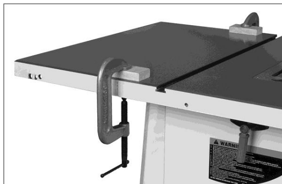
Рис. 5-6: выравнивание удлинений стола, способ 2
