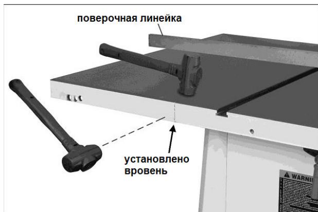
Рис. 5-5: выравнивание удлинений стола, способ 1
