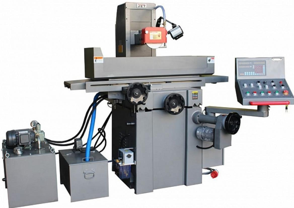
Плоскошлифовальный станок позволяет обрабатывать поверхность заготовок размером до 500x200x350 мм. Плавное перемещение рабочего стола (продольное) осуществляется со скоростью от 7 до 25 м/мин благодаря салазкам V-образного.
