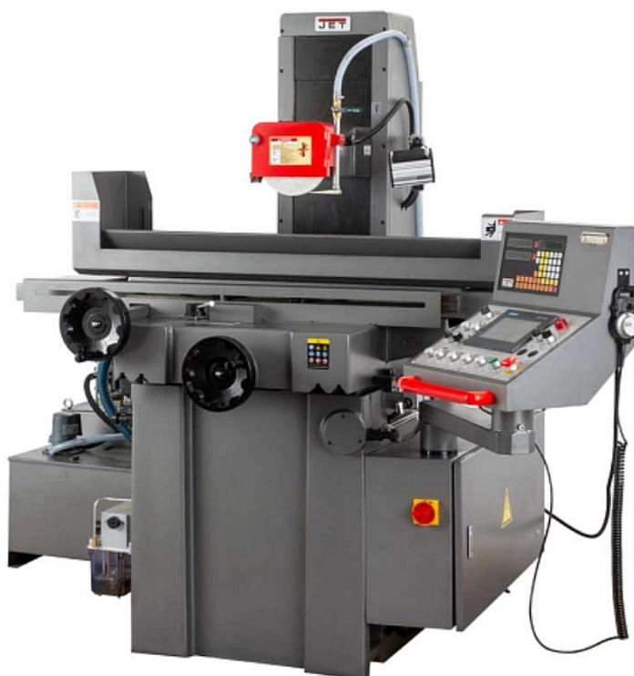
Плоскошлифовальный станок позволяет обрабатывать поверхность заготовок размером до 500x200x350 мм. Плавное перемещение рабочего стола (продольное) осуществляется со скоростью от 7 до 25 м/мин благодаря салазкам V-образного типа.
