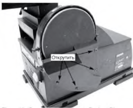
Рис. 14 Снятие крышки для замены круга
