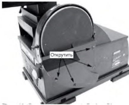
Рис. 14 Зняття кришки для заміни круга
