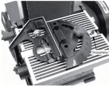
Рис. 12 Встановлення кутового упору
