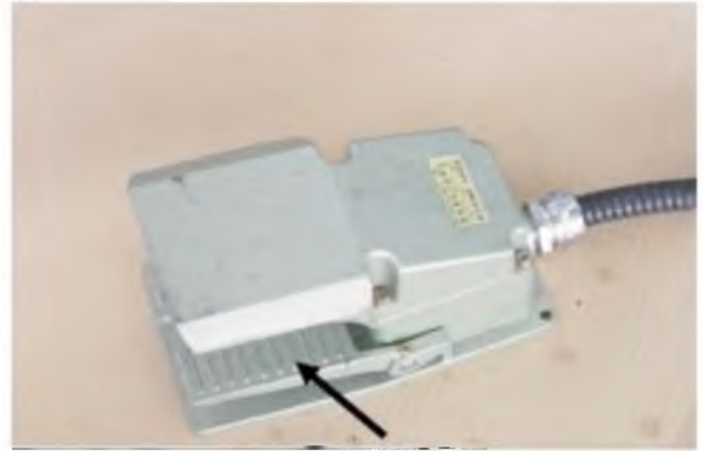
Рис. 6 – Ножная педаль для закрытия цанги
