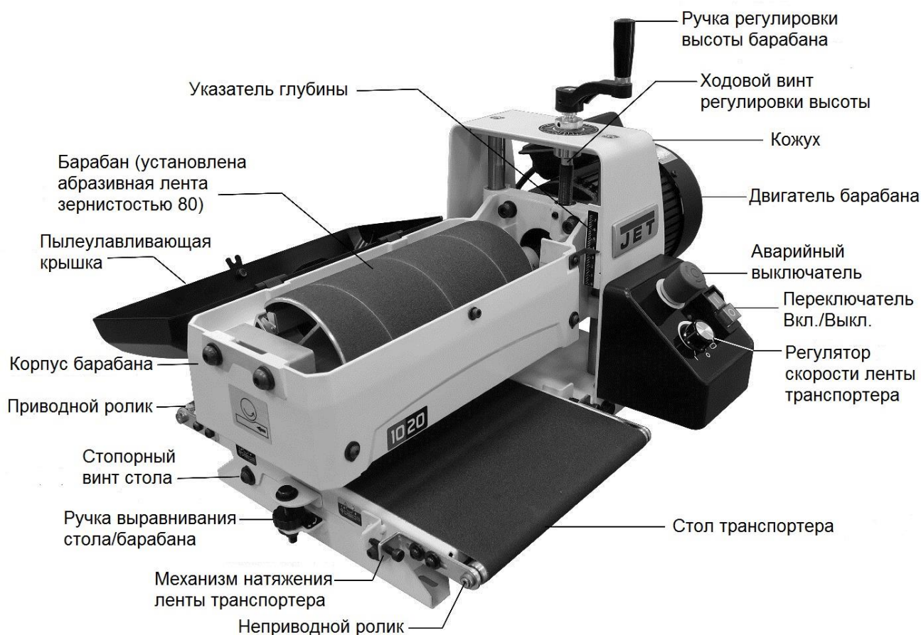
Рисунок 4-1: основные узлы станка
