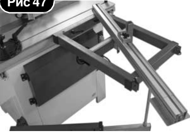
Упор рамы удлинения стола, установленный под углом 45°
