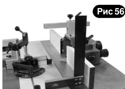
Установите угольник 90 ° вплотную к упору и проверьте его перпендикулярность к поверхности стола
