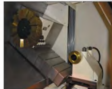
Револьверная голова и гидравлическая пиноль задней бабки
