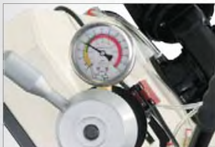
Тензометр контроля натяжения полотна
