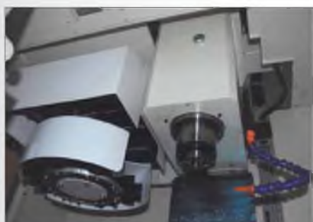
8-позиционный инструментальный магазин с механизмом смены инструмента
