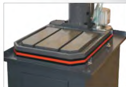
Стол со встроенной системой подвода СОЖ
