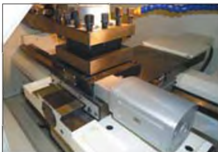
4-х позиционный резцедержатель с автоматической сменой инструмента
