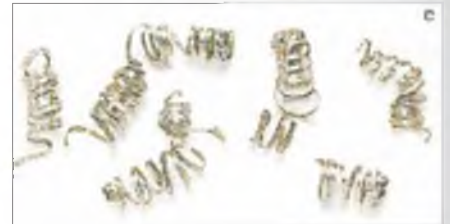
Свободно намотанная (витая) стружка - идеальные условия резания
