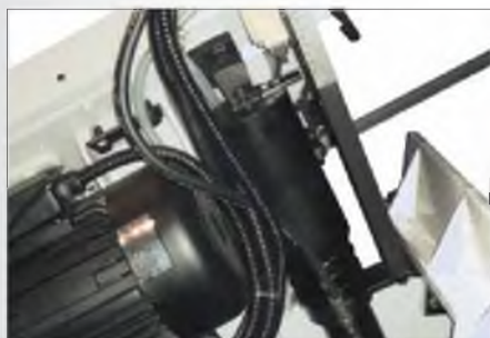
Гидроцилиндр подъема рамы с регулируемым концевым выключателем
