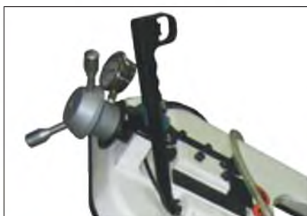
Рукоятка для ручных работ и механизм натяжения ленточного полотна
