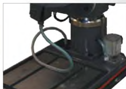
Система подвода СОЖ, встроенная в основание
