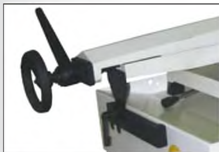
Быстрозажимная эксцентриковая рукоятка подвижной губки тисков
