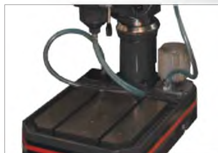
Подставка со встроенной системой подвода СОЖ
