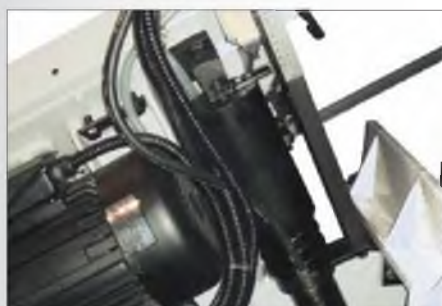
Гидроцилиндр подъема рамы с регулируемым концевым выключателем
