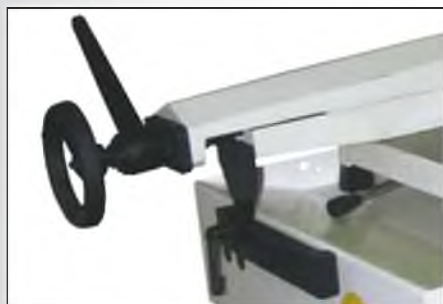
Быстрозажимная эксцентриковая рукоятка подвижной губки тисков
